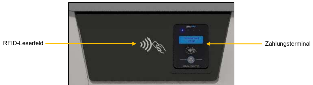
Abbildung 3: Position der RFID-Leserfeld und Zahlungsterminal
