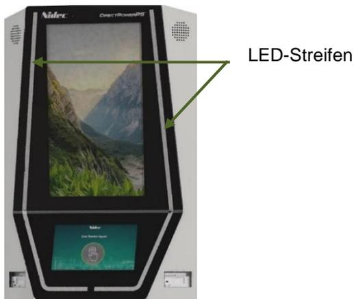
Abbildung 9: Position der LED-Streifen
